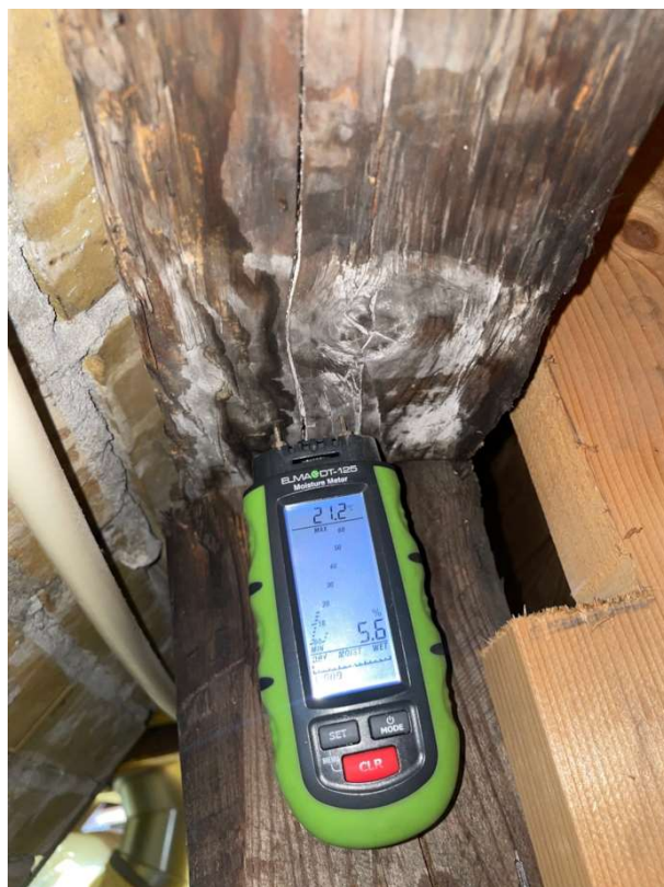
Indstiksmåling omkring udtræk
