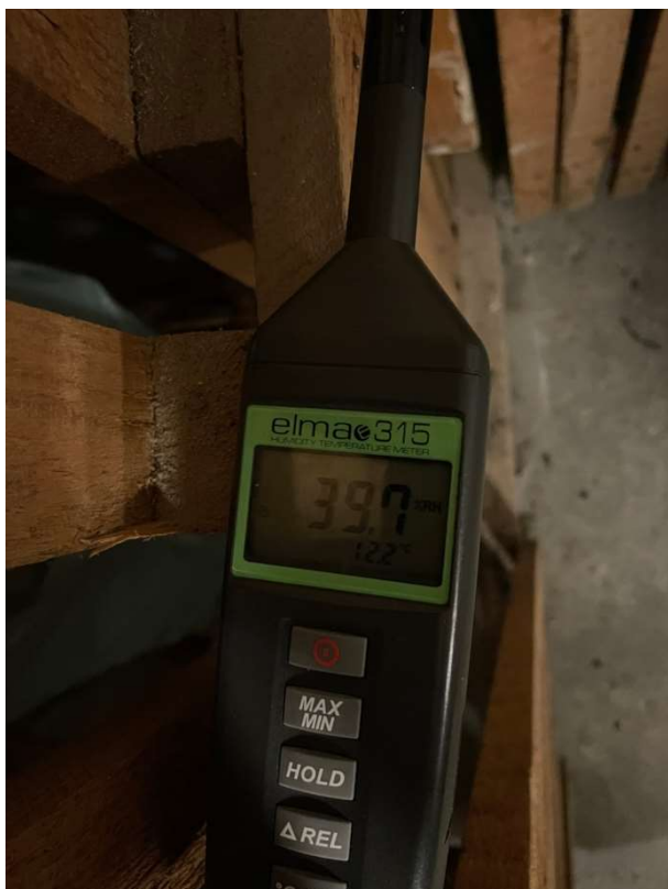
Måling af den relative luftfugtighed: 39,7% ved 12,2 grader
